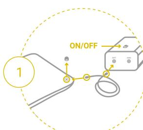
Odvijte pokrov ventila in privijte navojni del cevi v ventil na blazini, drugi del pa pritisnite v mehko vtičnico na tlačilki in jo vklopite. Počakajte, da je blazina dovolj mehka, nato pa izklopite tlačilko.
