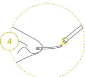
Zategnite črpalko za cev in izsesajte zrak in dobili boste željeno trdoto.
